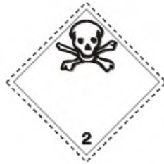
(№ 2.3) Ядовитые (токсичные) газы Символ (череп и скрещенные кости): черный; фон: белый; цифра "2" в нижнем углу
