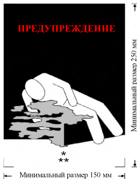
Знак, предупреждающий об охлаждении/кондиционировании, вагонов и контейнеров
